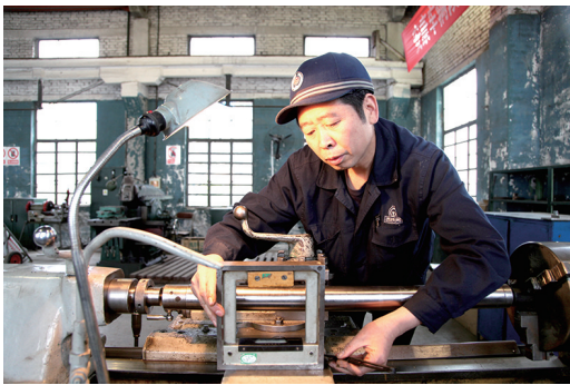
连日来,中国铁路西安局集团公司安康车辆段结合春季设备安全大检查,加强对老旧设备等重点整修,及时消除隐患,全力提升质量,为车辆安全运行提供保障。图为4月13日该段设备车间职工利用水平仪检修车床。 □ 周道刚 摄
