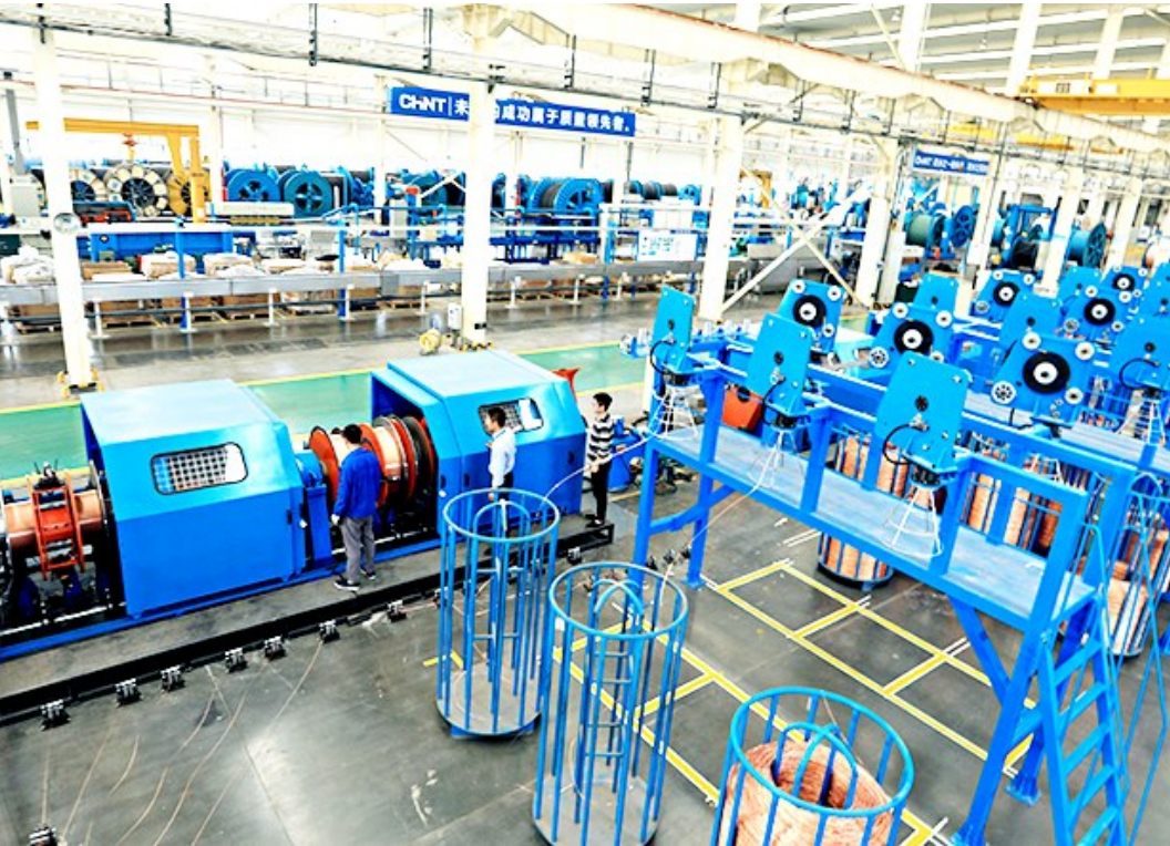
为确保提质增效,满足市场各类需求,咸阳正泰电器公司一次性投资1100多万元,购置双放双收盘框互切式分电机铜拉丝机、54盘铜芯式绞线机各一台(套)。随着两台(套)设备的安装、调试和正式投产,同类产品的产能将扩大三倍以上。
