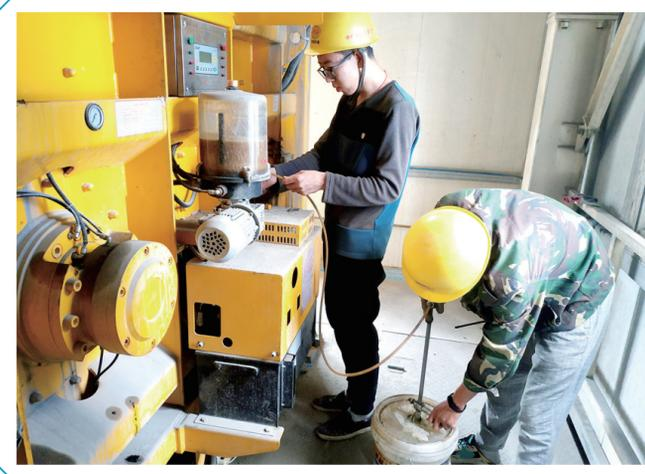
4月17日,中铁十二局四公司混凝土二公司兴泉铁路一号拌合站维修工正在检修线路,给轴承打黄油,对搅拌机进行日常维修保养,他们已经形成了定时保养的工作习惯,全力保障设备正常运行,确保混凝土生产稳步推进。
