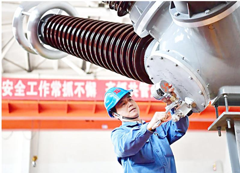
↑胡步洲在一台高压开关的气室上装气压力表
