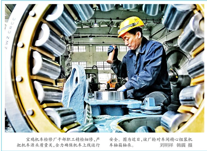
宝鸡机车检修厂干部职工精检细修,严把机车源头质量关,全力确保机车上线运行安全。图为近日,该厂轮对车间精心组装机车轴箱轴承。刘明祥 韩晨 摄
