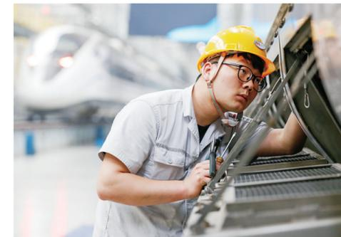
春夏之交,为保障旅客平安、舒适乘车,中国铁路西安局集团有限公司西安动车段扎实开展防暑准备工作,盯紧车厢空调组件、车内排水系统以及各部通风散热装置的检查及清洁作业,严格卡控作业质量,高标准推进整备任务。图为西安动车段团员青年正在检查、清洁车侧滤网。
