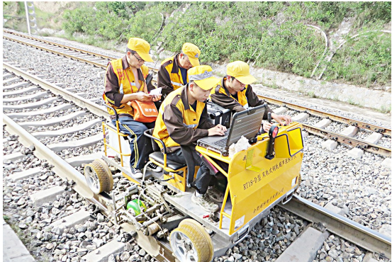
为了全面提升西平线(西安~平凉)设备质量,宝鸡工务段探伤小组,采取传统探伤仪和新启用的“双轨制钢轨超声波探伤仪”相结合的方式,对钢轨设备进行探伤大会战,钢轨伤损病害的检出率和探伤作业效率大幅提升。图为该段职工使用“双轨制钢轨超声波探伤仪”探测钢轨病害。 杨晓文 摄
