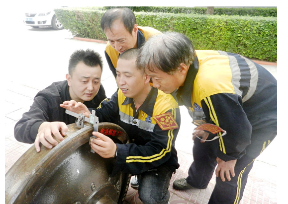
西安东车辆段近日在一线班组开辟职教“小课堂”,将车辆易发故障、暑期劳动安全关键、现场量具使用等内容纳入“小课堂”,以“我做你看、边说边练”的形式开展业务帮教,提升一线班组的业务技能和车辆检修品质。图为该段职教员讲透量具使用方法。 贾智炜 摄
