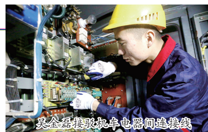
吴金磊拼接机车电器间进线线
