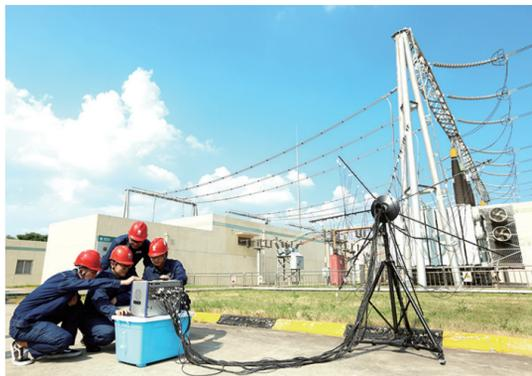
近日,在西安市上苑330千伏变电站,工作人员采用自主研发的变电站噪声精确定位系统,对主变压器进行噪声源定位测试,为降低噪声提供技术支持。
