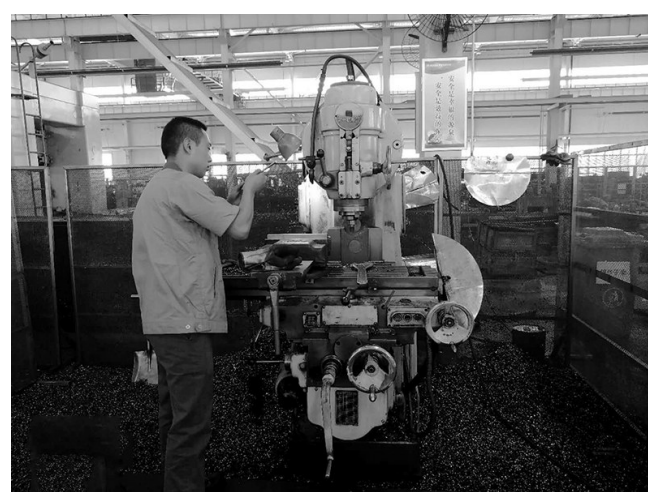
10月17日早11点,随着最后一道铣削程序的完成,西煤机公司工艺技术部研发的焊接坡口加工工艺方法成功落地。此种坡口结构主要应用于激光焊接,激光熔敷技术。此次激光焊试样坡口加工成功,标志着此项加工技术的研制成型,保证了激光焊接技术研发应用,有效推动西煤机公司产品的品质提升。侯军 摄
