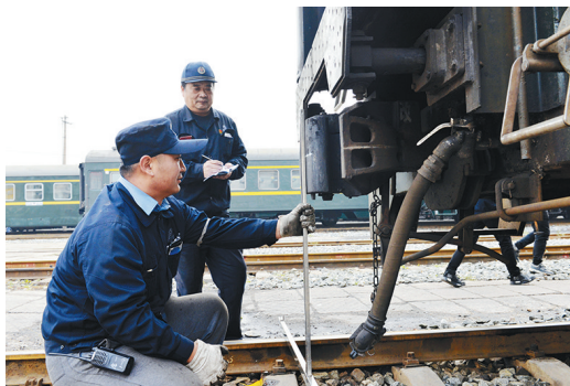
连日来,中国铁路西安局集团公司西安客车站针对冬季客车设备易发故障,加强对列车车钩、轮对及基础制动等易折、易裂部位的检查维修力度,消除安全隐患,确保旅客列车“零故障”上线运行。图为该段库内作业人员精心检查测量列车车钩技术状态。 □通讯员 赵伯顺 摄
