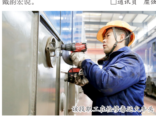
该段职工在检修春运机车头
