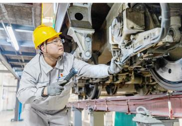
中国铁路西安局集团有限公司西安动车段组织加大春运期间动车组检修力度,确保春运期间动车组安全运行。因为近日机械师对动车组转向架进行检查。张文 摄
