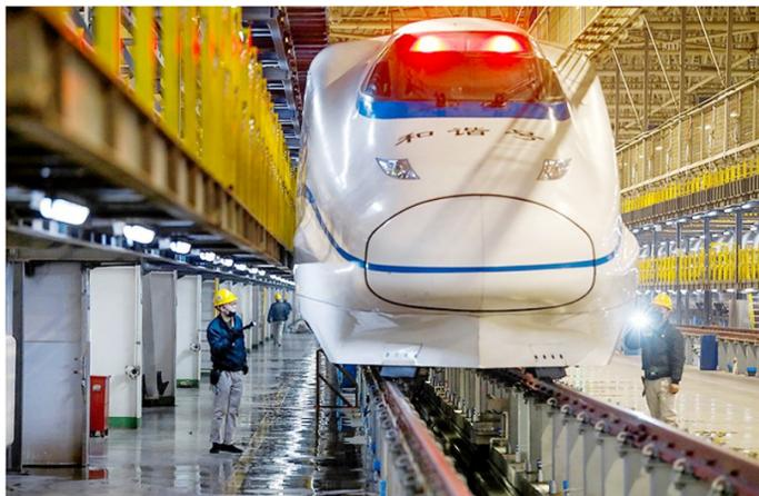
为确保2019年春运动车组运行安全,中国铁路西安局集团有限公司西安动车段全面加强了对动车走行部等关键部件
