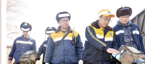
春运期间车流量猛增，中铁西安局集团公司延安工务段探伤工利用超声波探伤仪，以确保铁路运输安全。图为近日探伤工们正在甘钟线对蒲城站线路、道岔进行探伤作业。 常恒 摄
