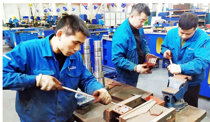
3月15日,在秦川机床厂装配车间,职工张海红(左一)正和工友进行一项特殊工序——“刮研”。据了解,刮研就是将不能用
