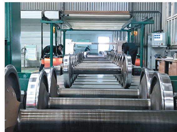
为确保新图顺利实施,提升运力,中国铁路西安局集团有限公司西安东车辆段严控检修工艺,提供优质轮对,确保运输需求。图为近日该段车轮车间职工正在对轮对进行组装、校验。 贾智炜 摄
