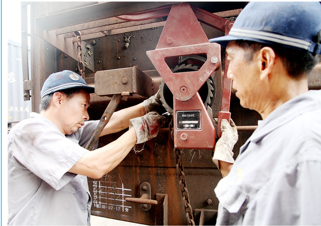
为确保货运增量,连日来,中国铁路西安局集团公司安康车辆段集中开展破拆车整治,全力消除车体、制动装置、走行部等部位故障,以优质车辆保证铁路运力需求。周道刚摄
