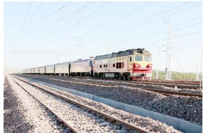
8月16日早上8点整，中国铁路西安局第一列动态检测列车55201次从靖边东车站开出。此次开行的动检测列车主要任务是检测区间内轨道、信号、通信、接触网等是否达到运营条件，为浩吉铁路按时开通做准备。韩永刚 摄
