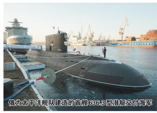
俄为太平洋舰队建造的首艘636.3型潜艇交付海军 为是当前最安静潜艇之一。该型潜艇长73.8米、宽9.9米,航速达20节,最大潜深300米,自持力45天,潜艇乘员52人,潜航排水量4000吨,战斗力较之前型号有大幅提高。 莫京娜 摄
