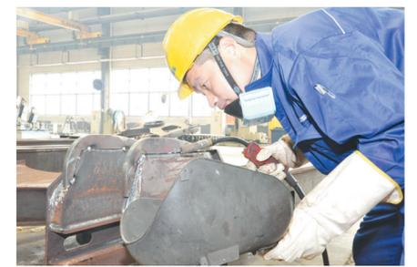
挖掘机动臂是工作装置的关键件。为了创新一套适合动臂半自动焊的管夹工装,他常常深夜还在生产现场徘徊思索。经过反复推敲、验证、试验,一台万能动臂焊管夹工装终于试制成功,并被应用到挖掘机各机型的动臂焊焊,工友们称其为“马红管夹”。从2012年到2018年的6年间,他自制和改进了50多种挖掘机焊接工装,生产效率提升所产生的直接和间接经济效益达百万元。
