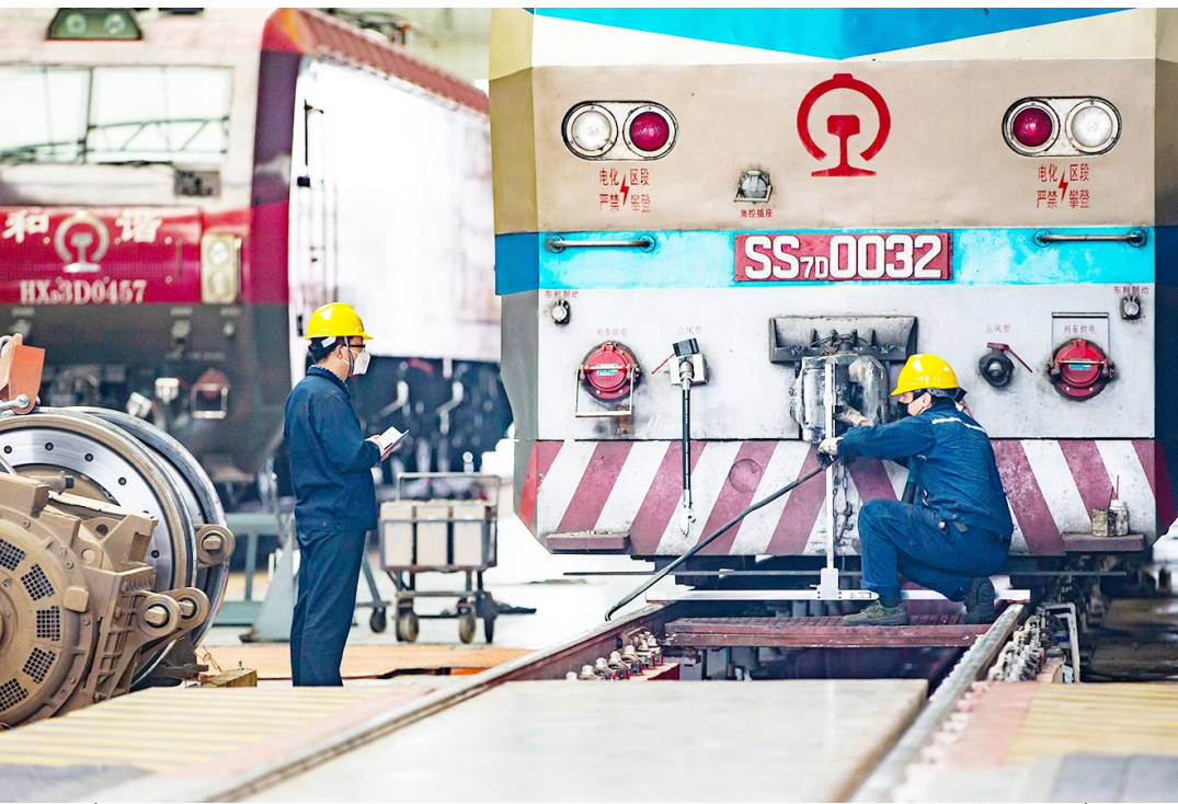
中国铁路西安局集团有限公司西安机务段在坚持执行疫情防控措施的同时,精检细修每台客运机车,为复工复产提供充足的运输动力。图为2月24日检修人员测量机车车钩状态参数。刘翔 摄
