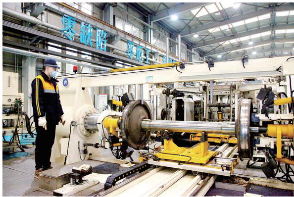
3月3日,中国铁路西安局集团有限公司西安东车辆段职工进行车辆轮对压装作业。 师欢 摄
