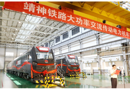
6月16日,陕西铁路物流集团靖神铁路6台“陕煤号”电力机车交验,该机车单台牵引功率14400千瓦,可满足靖神铁路万吨列车牵引作业需求。 潘培玉 张喆 摄
