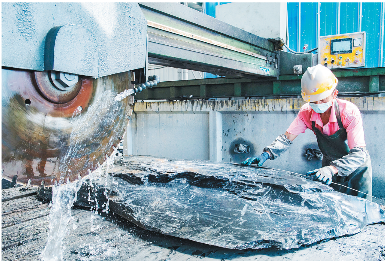
8月2日,在苏陕协作项目陕西镇坪鑫大地建材有限公司,工人利用大型机械进行砾采加工低碳环保的天然建筑材料——瓦板岩产品。
