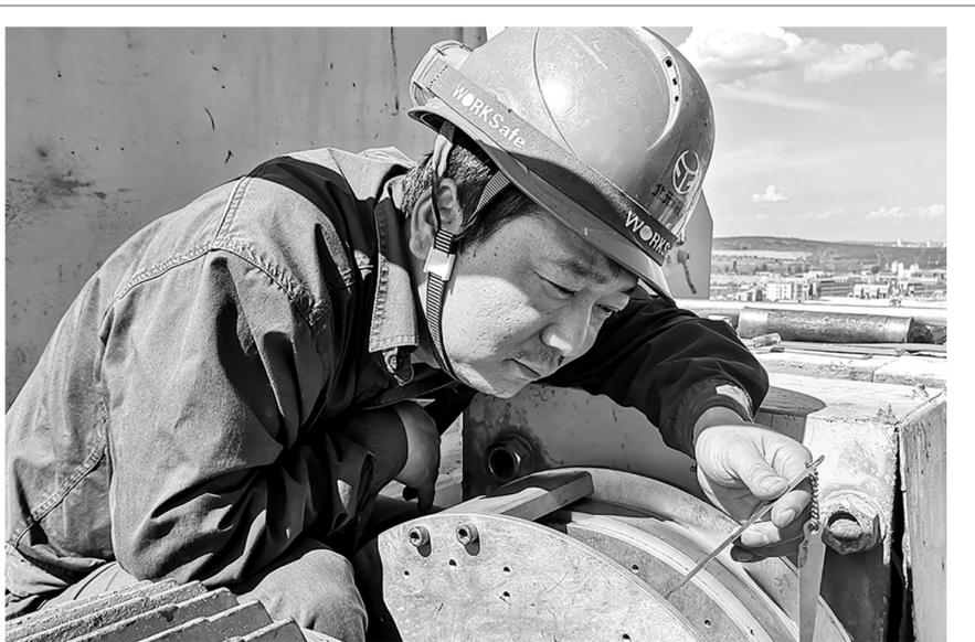
近日,北元水泥公司在入窑斗提顶部安装了磁性联轴器,经过试车,效果良好。据悉,水泥生产线大型设备较多,联轴器磨损、振动、漏油问题仿佛成了一道绕不过的“坎”,每次检修都要对斗提机、风机等设备联轴器进行维修,不仅增加了检修人员的劳动强度,还制约着设备使用效率。为了解决生产运行瓶颈,该公司通过多次对
