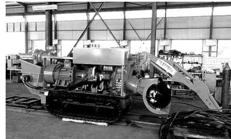
近日,韩城矿业公司象山矿并新投用的KQY75重型清仓机器人,只需3人远程遥控操作,可达到每日清仓距离50米以上,实现了人工根本不能清理煤泥、输送原煤和脱水的目标,提高了生产效率和安全性,代替了人工清淤作业,成为了水仓清理的主力军。
