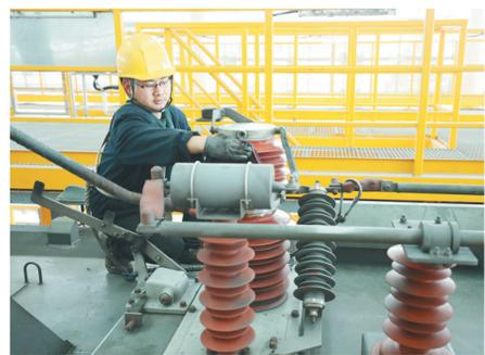
近日,中国铁路西安局集团有限公司安康机务段对配属的205台电力机车开展防“闪络”专项整治,对入库机车车顶绝缘子去污保洁,做到趟趟清扫,确保各部位无杂物、无灰尘、无油污,有效预防车顶“闪络”问题发生,确保行车安全。 □石伟村 摄
