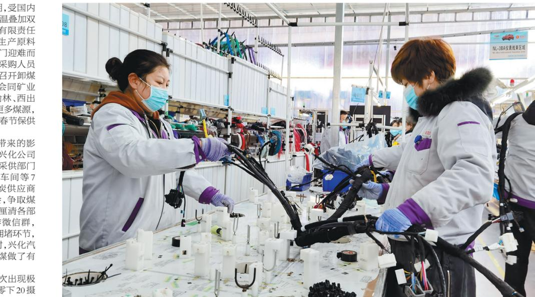
近日,陕西双翼飞电气系统有限公司开足马力生产,工人们正在装配为吉利博越配套的整车线束。该公司是生产乘用车、商用车和工程机械线束的专业厂家,具备年产10万台套汽车线束的生产能力,主要为吉利汽车宝鸡制造基地、秦晓基地提供配套产品。2020年下半年,累计生产汽车线束1.2万台套。 □徐小红 摄
