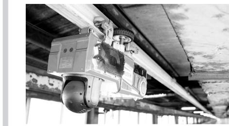
近日,在铜川矿业玉华矿洗选系统移动巡检机器人走上新岗位,它能在多种环境下,实现全天候数据快速采集、实时信息传输、智能分析预警、快速决策反馈的闭环管控,代替人工对运输系统进行智能巡检,推进“智慧矿山”建设向前迈进了一大步。 朱建锋 杜玲玲 摄
