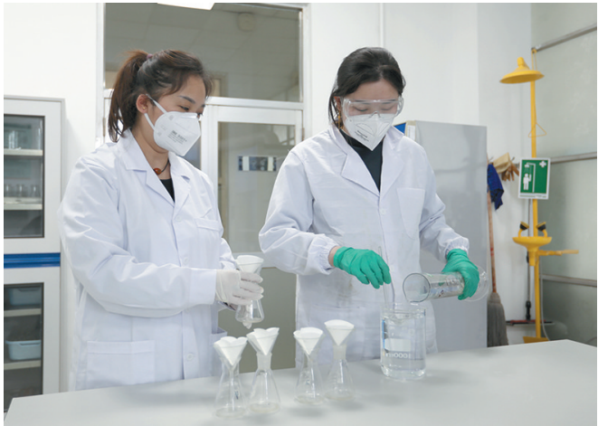
3月2日,咸阳烟叶复烤有限责任公司化学分析员在烟末中加入5%的萃取液,将所需检测的化学成分溶于萃取液中等待过滤。据悉,该实验室是全国烟叶复烤行业第一个恒温恒湿实验室。 □魏锋 摄
