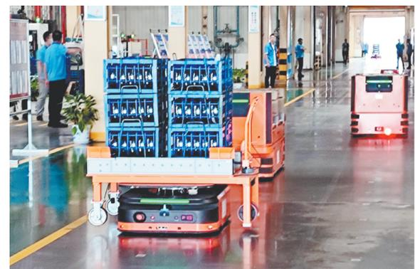
8月26日，在法士特集团三万三联合生产车间，自动驾驶运输车(AGV)正将物料从智能立库运送到生产现场。今年以来，该集团瞄准“电动化、智能化、网联化、共享化”行业发展方向，以生产线改造升级为基础，大力推进智能制造。
