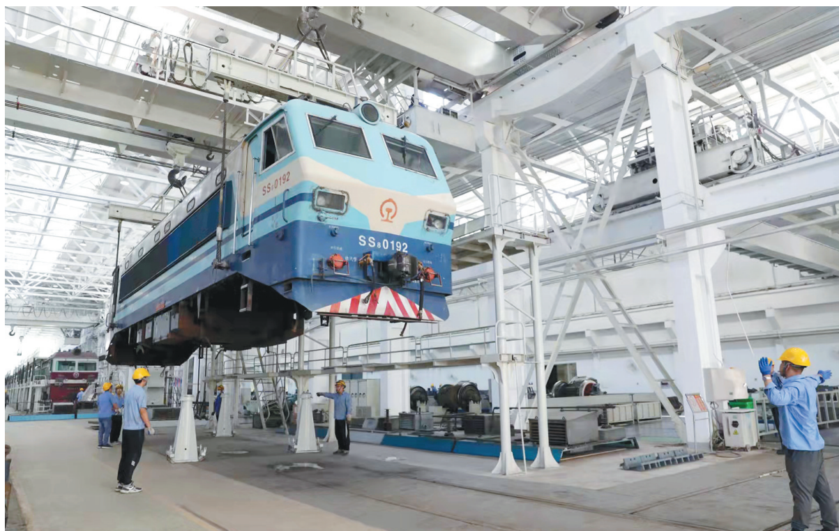
双节期间,中国铁路西安局集团有限公司宝鸡机务段检修厂把机车关键部件质量关,确保出库机车质量优良、安全上线运行。图为该厂职工严格按标准抬车解体电力机车。 □赵选团 摄
