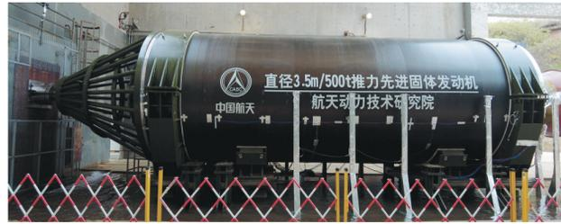
我国自主研发、推力达500吨的整体式固体火箭发动机准备试车。
