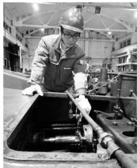
“报告班长, 3#氨泵处有大量液氨泄露。”“收到, 泵房岗位, 打开气防柜, 迅速穿好防护服, 佩戴空气呼吸器, 进入现场, 依次将3#氨泵进、出口阀门关闭, 并查看具体泄露部位。”
