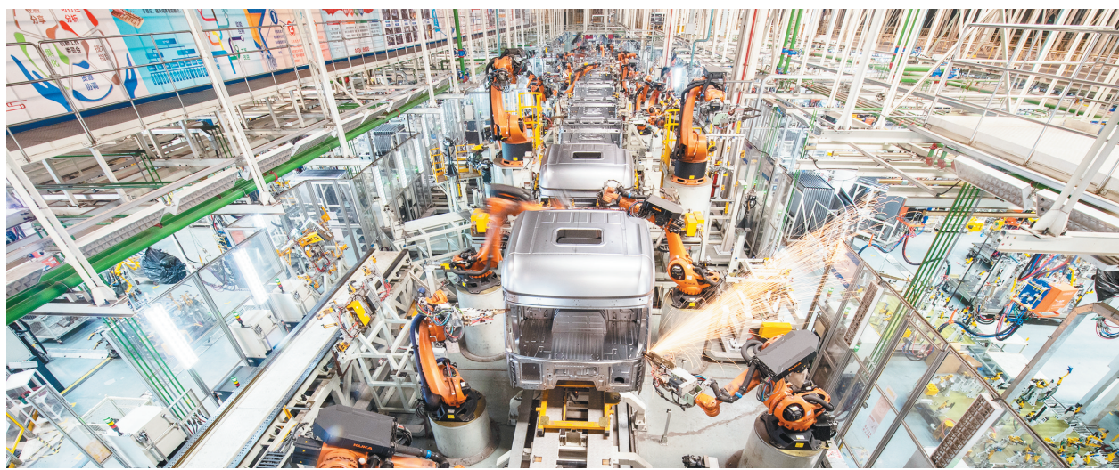
工业机器人在陕汽控股车身厂HD机器人生产线上作业。陕汽积极发挥企业创新主体作用,充分借助秦创原平台资源、技术和人才优势,进一步激发了企业发展动能。今年前11个月累计生产汽车18.5万辆、销售汽车19.28万辆,取得了“十四五”良好开局。袁景智摄
