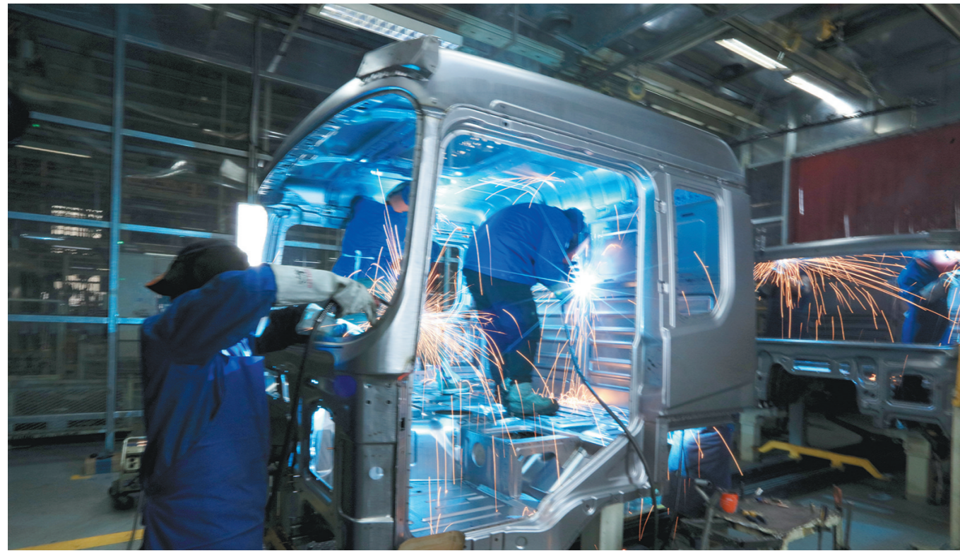
1月23日,在陕汽控股西安商用车产业园车身厂生产车间里,工人在重卡驾驶室生产线上进行焊接收作业。朱鹏飞 摄
