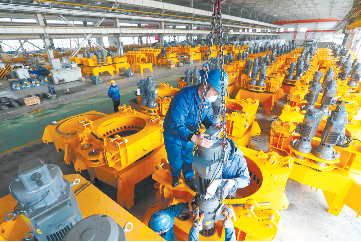
2月8日，陕西建设机械股份有限公司工人正在组装塔式起重机的回转机构。 肖晓良 摄
