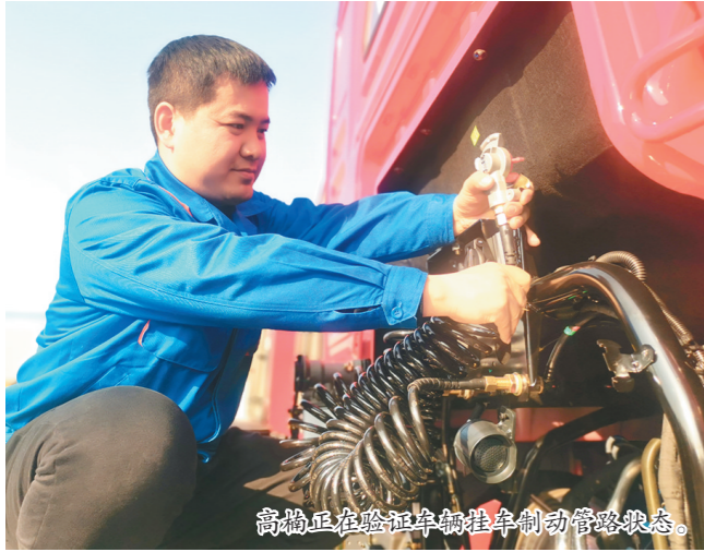
高楠正在检查车辆制动管路状态。
