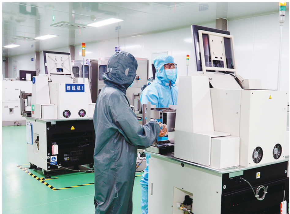
4月13日,陕西群力电工有限责任公司职工为产品光MOS继电器芯片焊线。连日来,该公司坚持疫情防控和安
