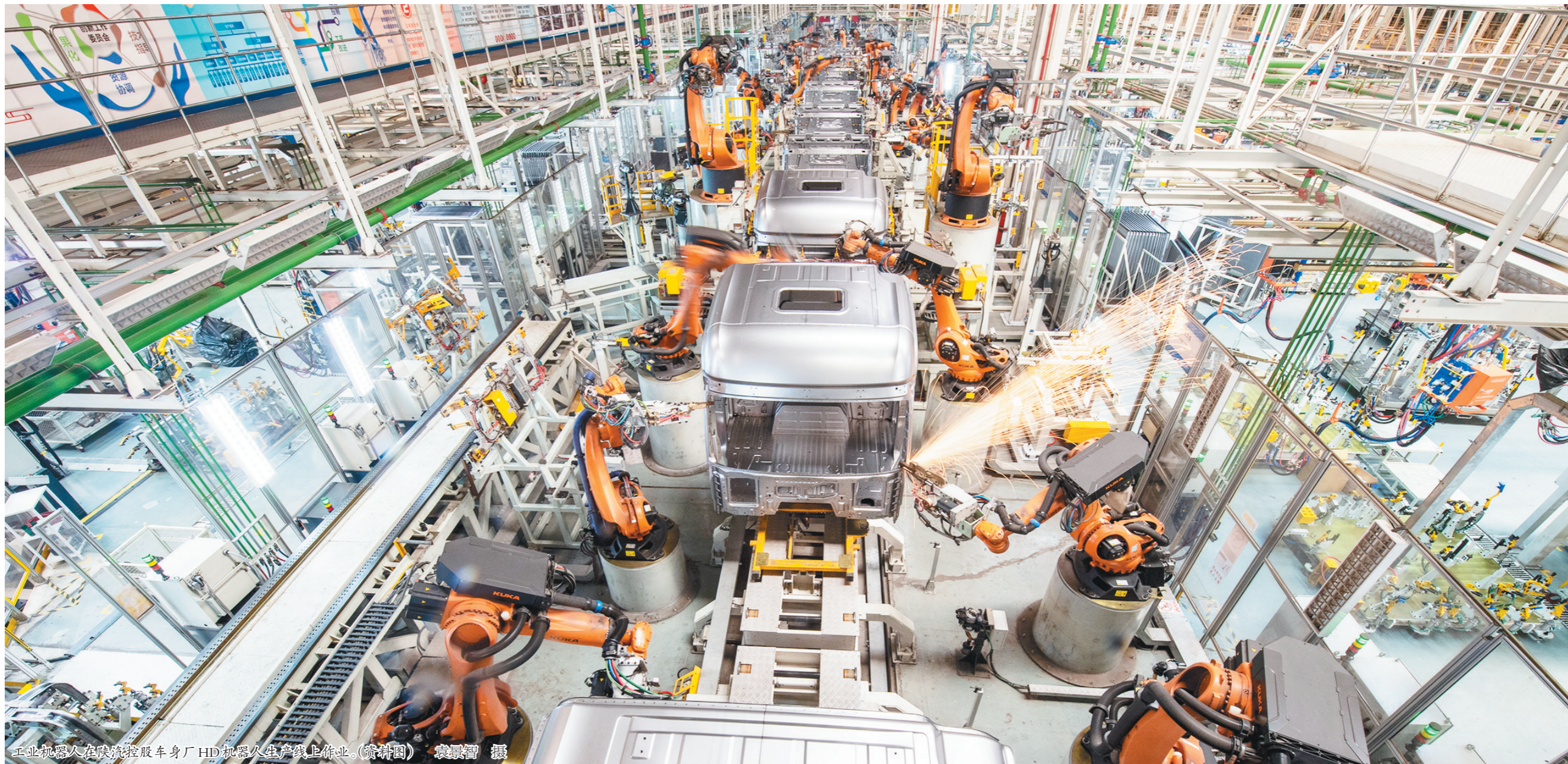
工业机器人在线检测车身厂HD机器人生产线上作业。(资料图) 袁斌 摄
