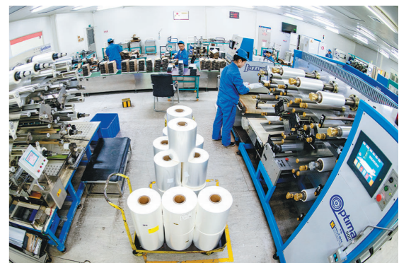
6月6日,工人在西安西电电力电容器有限责任公司卷制车间进行元件卷绕。今年前5月,西电西容订货已超2亿元,实现新增订货同比增长3%;工业总产值同比增长13%;外部营业收入同比增长15%;实现利润同比增长147%。袁景智 摄
