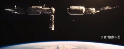
在轨期间，问天实验舱还将实现平面转位90度，这将是我国首次航天器在轨转位组装，也将是国际上首次探索以平面式转位方案进行航天器转位
