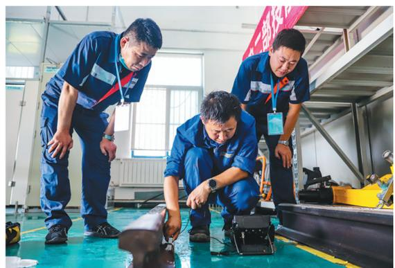
7月28日,西安市轨道交通集团运营分公司工电二部举行技能比武活动,确保夏日运营安全。比武由探伤、变电两个专业展开,项目包括故障抢修处理、设备图纸解析、仪器使用等内容。图为探伤专业员工在对钢轨伤损进行检测。 □张坤 摄
