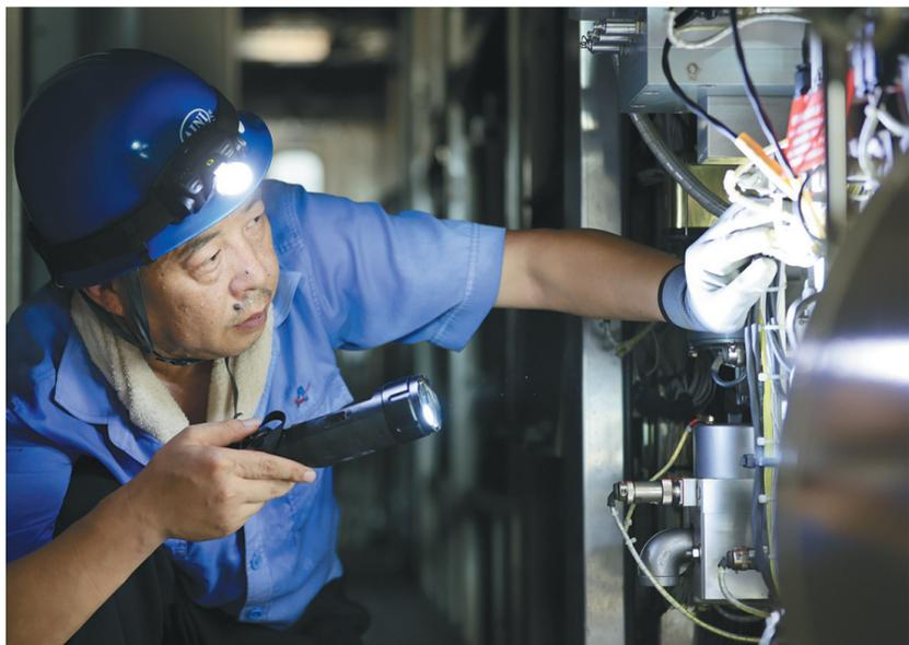
针对近期陕南持续高温天气,国铁西安局安康机务段积极“排兵布阵”,对全段配属的246台机车的制动系统、防汛设备、车顶高压设备、机车防火等暑期高风险关键部位进行检查整修,确保运输组织畅通有序。图为该段检修职工在超过50℃的机车走廊中检查机车制动柜。 □李德森 摄
