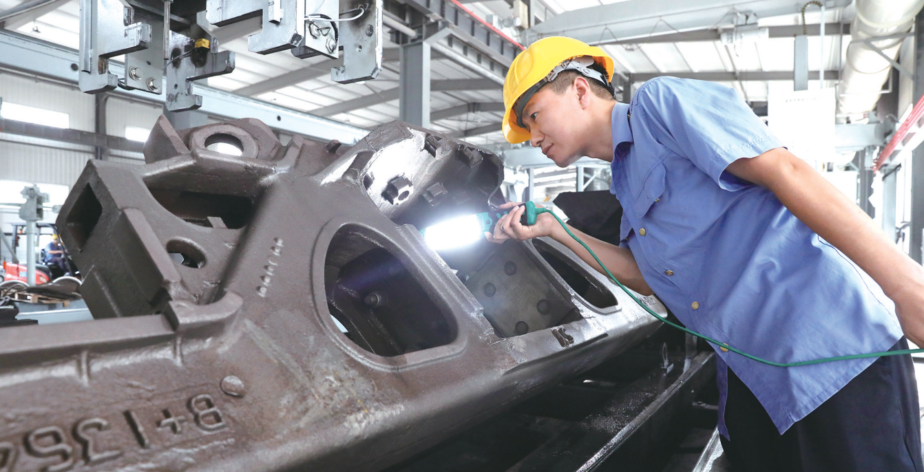
连日来,国铁西安局西安东车辆段紧盯车辆轮对、转向架、制动阀等作业关键环节,严控检修质量,为铁路运输提供优质车源。图为职工进行车辆侧架探伤作业。□师欢 摄
