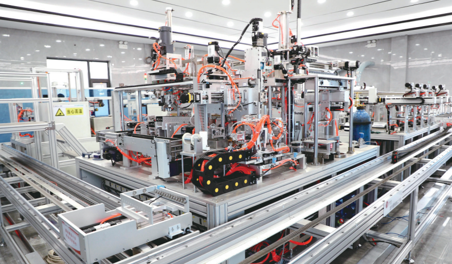
煤质智能检验系统自动完成检测工作。
