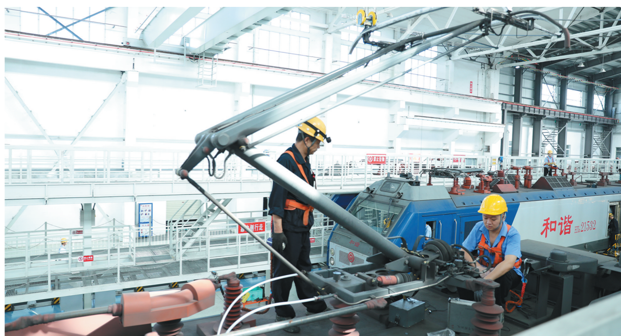
8月30日起,国铁西安局安康机务段为期60天的机车秋季整修工作全面展开。此次整修范围主要为配属的246台和谐电1型、电2型、和谐内燃5B型机车,针对机车防寒、
