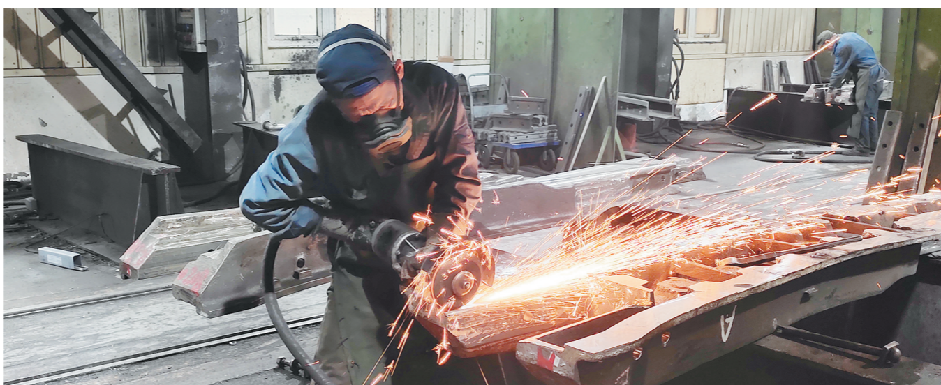
为喜迎二十大,中铁宝桥又分公司15个班组300余名干部职工在国庆期间一直坚守在工作岗位上。为全力保证北美自护式辙叉、国产辙叉、合金钢辙叉及重载钢辙叉等重点产品的生产,他们加班加点忙碌着。图为职工在打磨辙叉。
