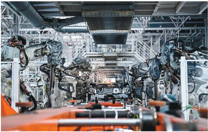
10月17日,在吉林长春中国第一汽车集团有限公司红旗繁荣工厂焊装车间内,焊装机器人在生产线上焊接车身。新华社记者 颜麟蕴 摄
